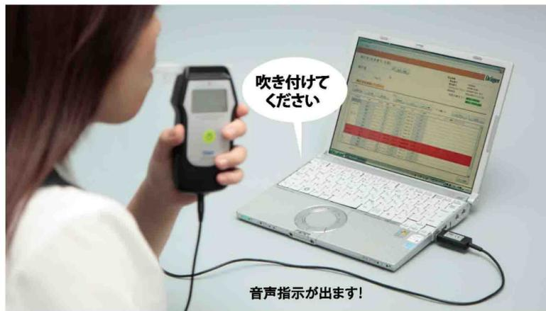
測定結果を個人名と合わせて管理することができるアプリケーションソフトです。アルコテスト3500をPCに接続してアルコールチェックを行ないます。測定の際に、あらかじめ登録した名前を選択し、音声指示に従って測定を行えば、個人名、測定時刻と合わせて測定結果が記録されます。データはエクセルなどのCSVファイルへ変換できます。吹き込み口のノズルは1人1人替えができます。パソコンと連動したことで、据置型としてもお使いいただけます。
